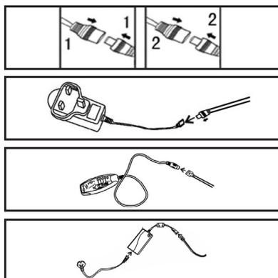
2. Kontrollieren Sie, ob die Stecker vom Motor zur Steckdose und vom Motor zur Fernbedienung eingesteckt sind und festsitzen.
