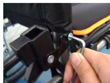
Lösen Sie mithilfe des 5 mm Sechskantschlüssels die Schraube, mit der die Rückenlehne am Rahmen befestigt ist. Nun können Sie den Winkel der Rückenlehnen anpassen und die Schraube mit der Kontermutter anschließend wieder festziehen.
