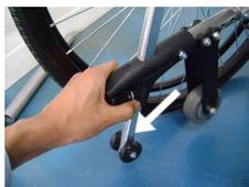
Erreichen Sie die gewünschte Höhe, kann der Verstellhebel losgelassen werden. Achten Sie jedoch darauf, dass der Kippschutz hörbar in einer der Lochungen einrastet und damit fest in der Halterung sitzt.
