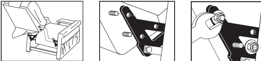
1. Positionieren Sie die Rückenlehne zwischen den Laschen, so dass die Löcher in den Halterungen mit den Gewindestangen der Rückenlehne übereinstimmen.
