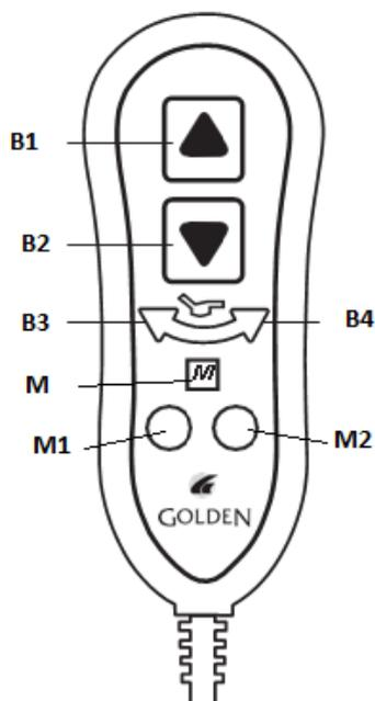
1. **Halten Sie zum Kippen der Rückenlehne** die Taste (B2) gedrückt, bis Sie die gewünschte Position erreicht haben, und lassen Sie dann die Taste los.
