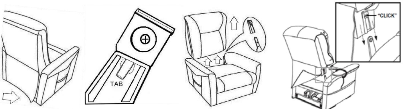
1. Richten Sie die beiden Halterungen, die sich auf den gegenüberliegenden Seiten der Rückenlehne befinden, unter dem Stoff und dem Sitz aus.
