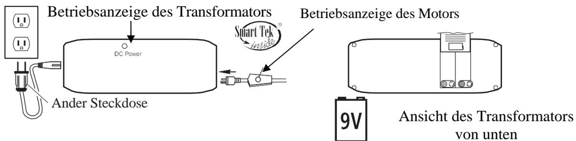
Legen Sie zwei 9-V-Pufferbatterien in den Transformator ein. Im Falle eines Stromausfalls können Sie in die Aufstehposition zurückkehren (nur ein einziges Mal möglich, wenn die Batterien in gutem Zustand sind).
